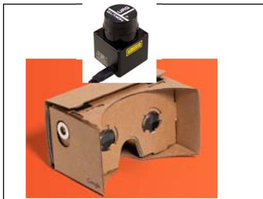
圖 2. 混合實境 HMD 的設計外觀 LRF 安置於護目鏡套之上沿。
